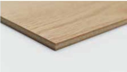
不燃仕様:表面:0.3mm以下天然木単板 +両面薄葉紙張アルミニウムはく張火山性ガラス質複層板 +裏面防水紙貼り
